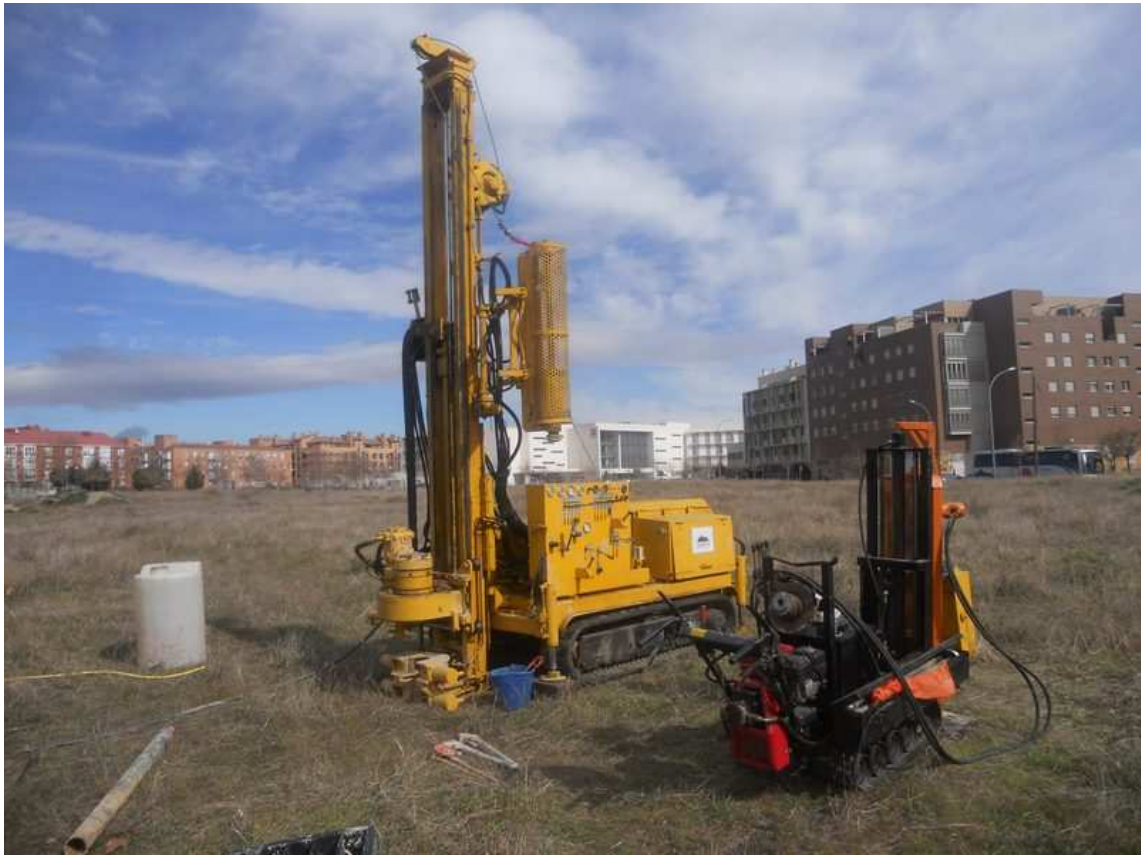
FOTOGRAFIA 1: Vista de la perforación del primer sondeo y penetrómetro: A
