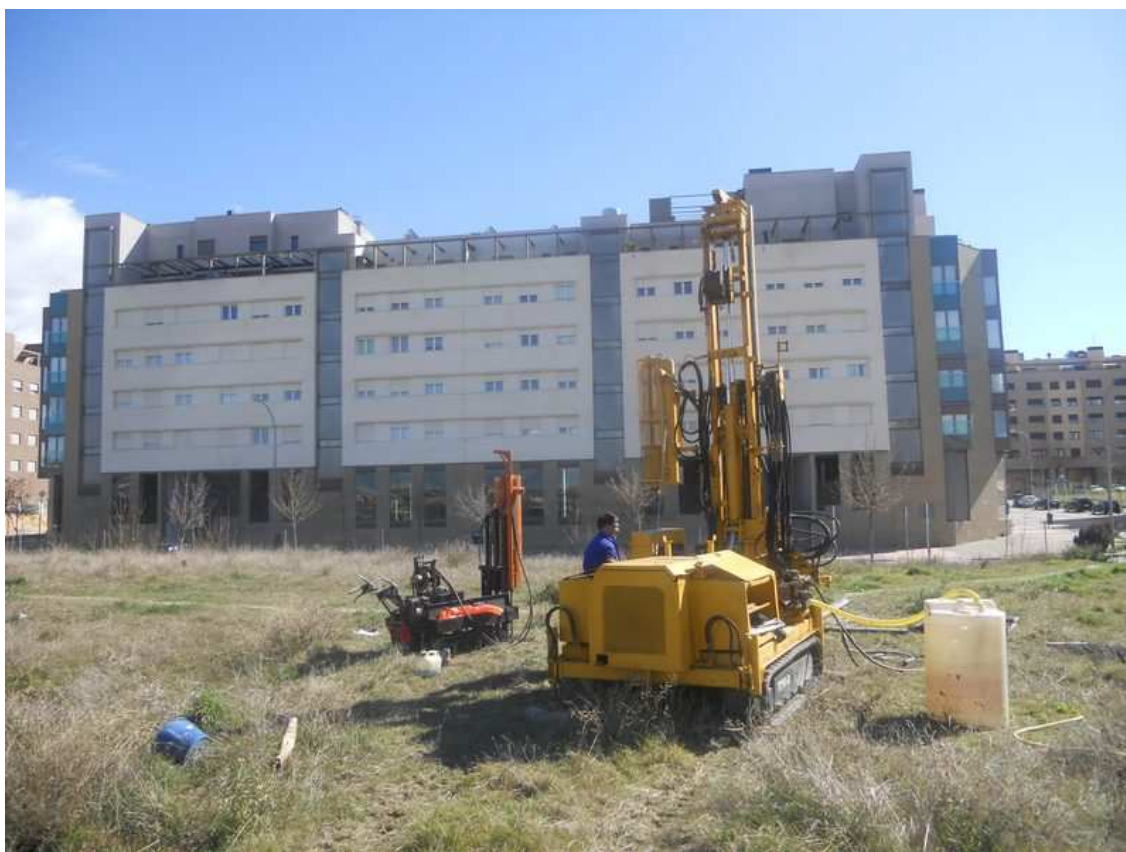
FOTOGRAFIA 5: Vista de la perforación del tercer sondeo y penetrómetro: C
